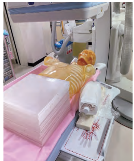
図1. Rad Board®使用時散乱線量の測定配置図
